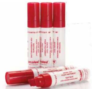
Bei verunreinigter Oberfläche sollten keine Teststifte angewendet werden, da die Restverschmutzung von der Prüffläche im Filz der Stifte zurückbleiben kann und spätere Werte verfälscht. Bei verunreinigter Oberflächen arcotest® Testtinte in Flaschen mit arcotest® Wattestäbchen verwenden. Nicht geeignet für Metalloberflächen.
